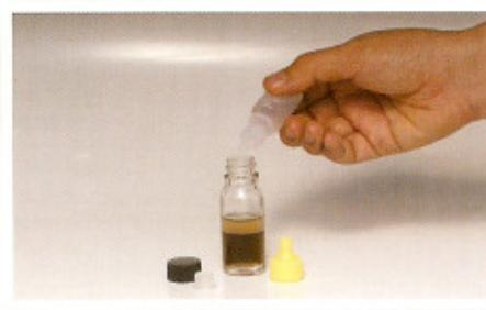
4. เติมน้ำยาทดสอบในขวดแก้วกลมเล็กจำนวน 0.5 มิลลิลิตร (ใช้หลอดฉีดยา) ปิดจุก และเขย่าขึ้นลง 10 ครั้ง ถ้าได้สีขาวขุ่นให้หยุดทดสอบและอ่านผลจากตารางช่องที่ 1 ถ้าสีน้ำเงิน-ม่วงหรือดำยังคงอยู่ให้เติมน้ำยาทดสอบเพิ่มอีก จำนวน 0.5 มิลลิลิตร ปิดจุกและเขย่า และอ่านผลในตารางช่องที่ 2
