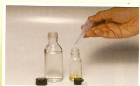
3. เติมน้ำยาทดสอบในขวดพลาสติกแบนจำนวน 4 มิลลิลิตร (ใช้หลอดหยดหลอดที่ 1 ดูด 2 ครั้งๆ ละ 4 ซีต) และเติมน้ำยาในขวดหยดจำนวน 2 หยด ปิดจุก และเขย่าขึ้นลง 10 ครั้ง เมื่อสารละลายแยกชั้น จะมีสีน้ำเงิน-ม่วงหรือดำ
