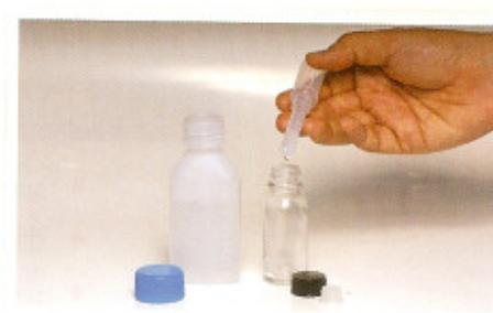
2. เติมน้ำมันจำนวน 1 มิลลิลิตร (ใช้หลอดหยดหลอดที่ 2 ดูดขึ้นมา 2 ซีต) และเติมน้ำยาทดสอบในขวดแก้วกลมใหญ่จำนวน 4 มิลลิลิตร (ใช้หลอดหยดหลอดที่ 3 ดูด 2 ครั้งๆ ละ 4 ซีต) ปิดจุก เขย่านาน 1 นาที
