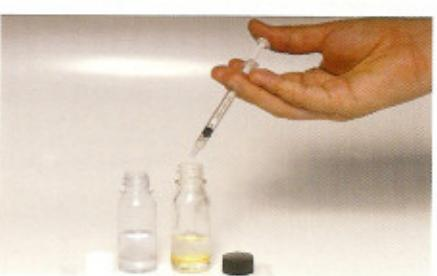
4. เติมน้ำยาทดสอบในขวดพลาสติกกลมโดยใช้หลอดฉีดยา ดังนี้
