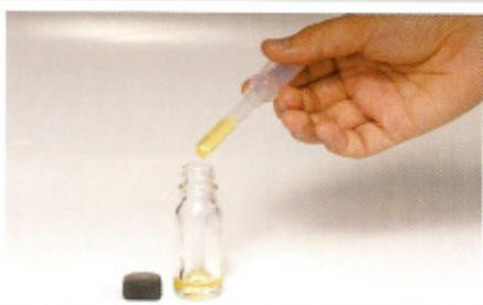
1. ใส่น้ำมันจำนวน 1 มิลลิลิตร (ใช้หลอดหยดหลอดที่ 1 ถูกขึ้นมา 2 ชีด) ลงในขวดทดสอบ
