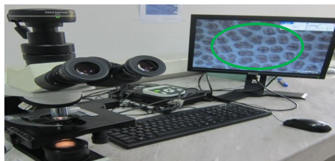
ภาพสาหร่ายภายใต้ compound microscope ที่กำลังขยาย 400 เท่า
